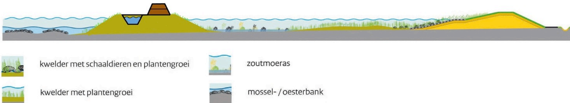
Dijk met biobouw en nieuwe wierde (Bewerking van tekening Deltaprogramma Waddengebied / 2014)
